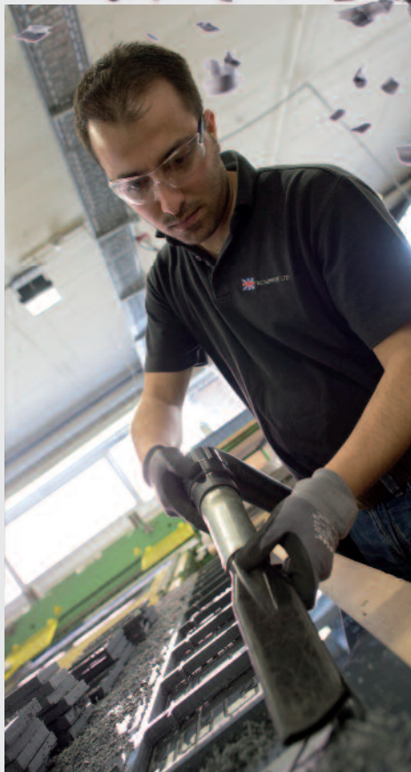
Aufsaugen der restlichen Späne
