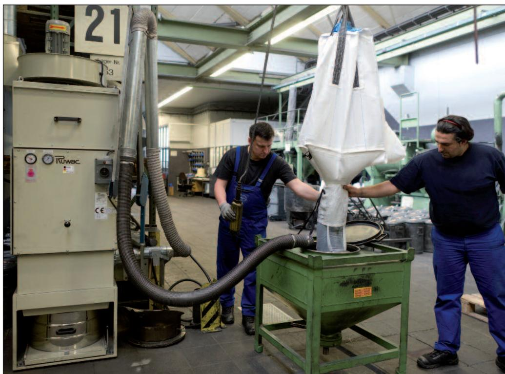
Direkte Absaugung beim Umfüllen des Metallpulvers
