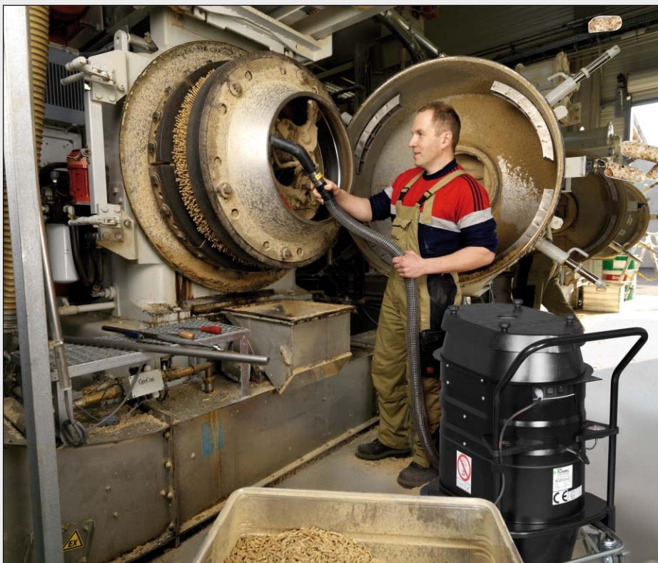
Hier werden Sägespäne aus einer Trommel gesaugt
