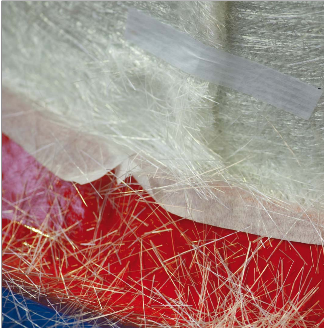
Matten aus Glasfasern - hier deutlich sichtbar
