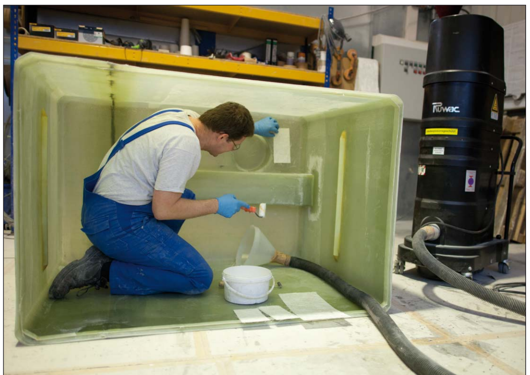
Der Ruwac saugt Stäube aus dem Behälter, der mal der Tank eines Löschfahrzeugs werden soll
